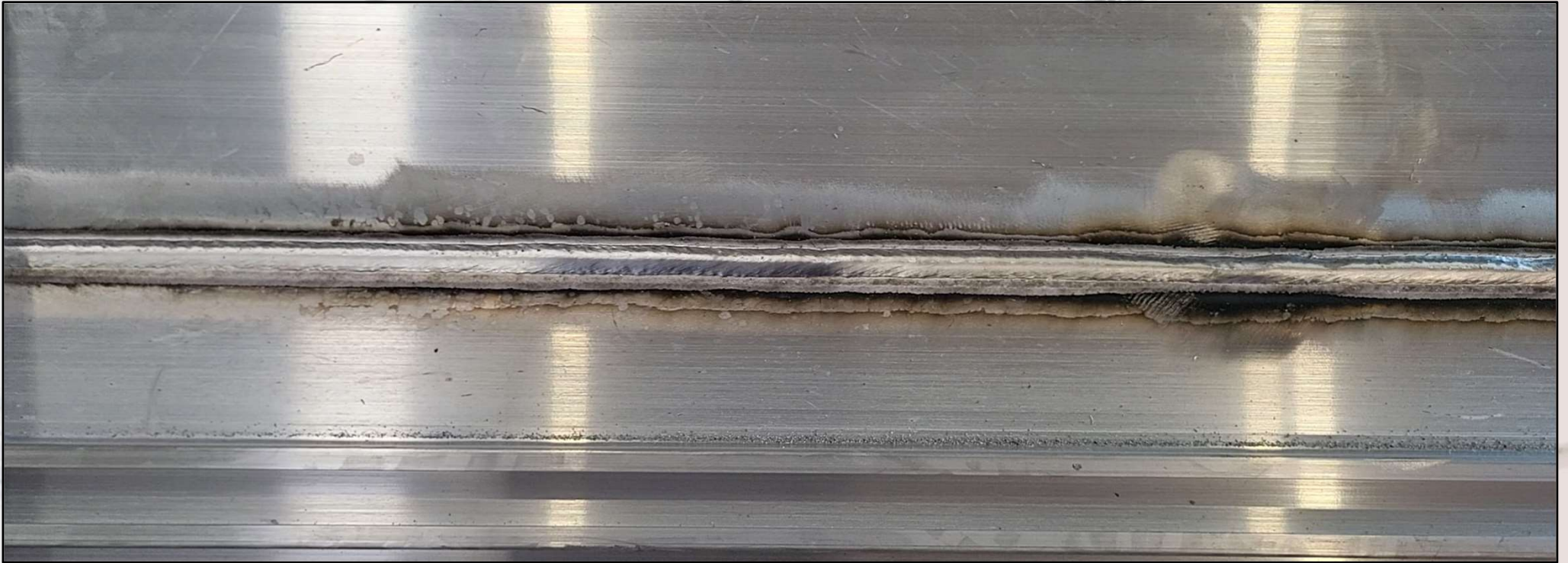
Twin Tandem Prozess - Drahtförderung durch eine Umlenkrolle
